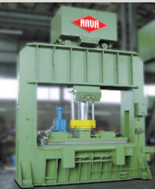
Vista di insieme dell'impianto flessibile Nava per l'idroformatura di pezzi tubolari
