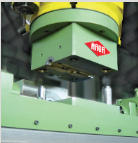
Particolare dello stampo di idroformatura realizzato da Nava
